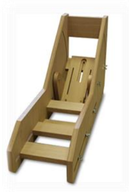
Слика 6. Изометријски динамометар (TF022-NEG1, ОТ Bioelettronica, IT)
